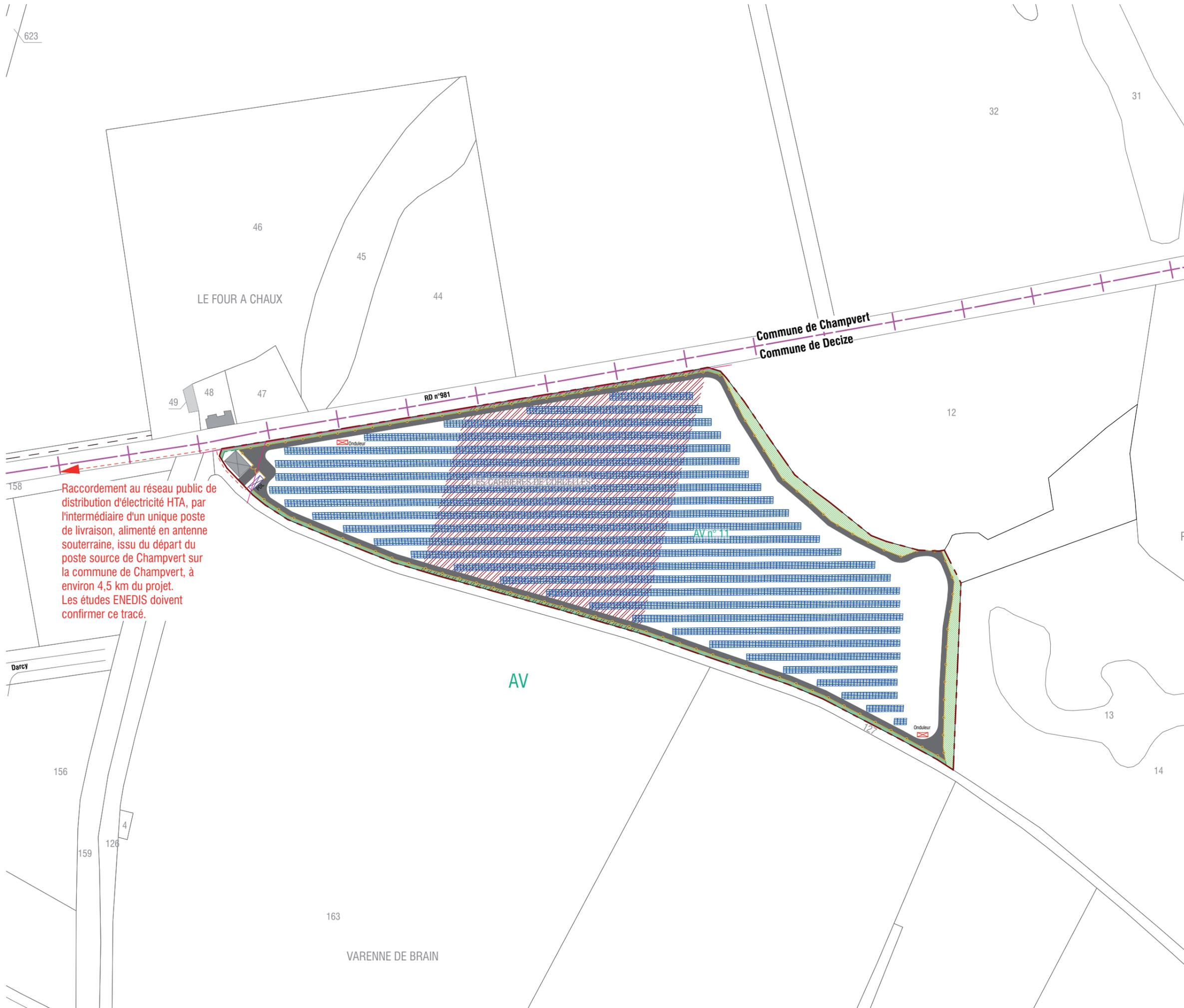
Raccordement au réseau public de distribution d'électricité HTA, par l'intermédiaire d'un unique poste de livraison, alimenté en antenne souterraine, issu du départ du poste source de Champvert sur la commune de Champvert, à environ 4,5 km du projet. Les études ENEDIS doivent confirmer ce tracé.
